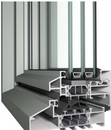
Driedubbel glas U-waarde = 0,8; kozijn minimaal U = 1,5
