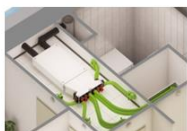
Ventilatie box boven het plafond
